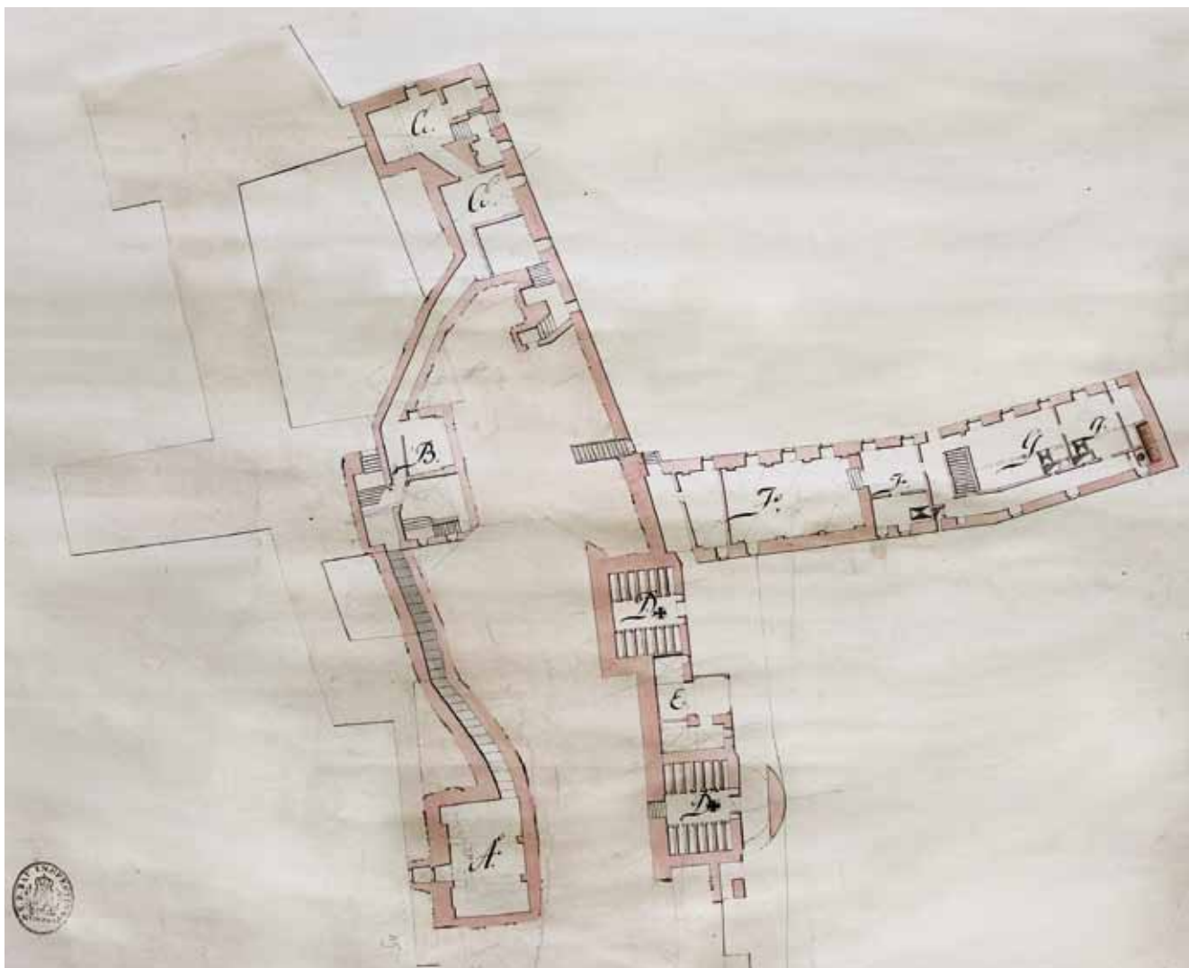
02 Grundriss der klostereigenen Keller unter der Kirche bzw. den Konventgebäuden: Märzenbierkeller (A), Essigkeller (B), Schenkeller (C) (Stadtarchiv Freising, Plansammlung)
